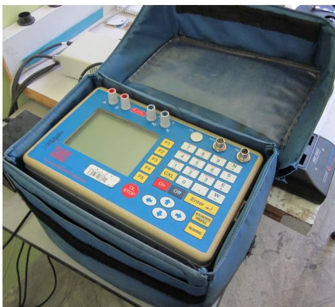
Fig. 1.8 Equipo para Tomografía eléctrica Saris Scintrex
