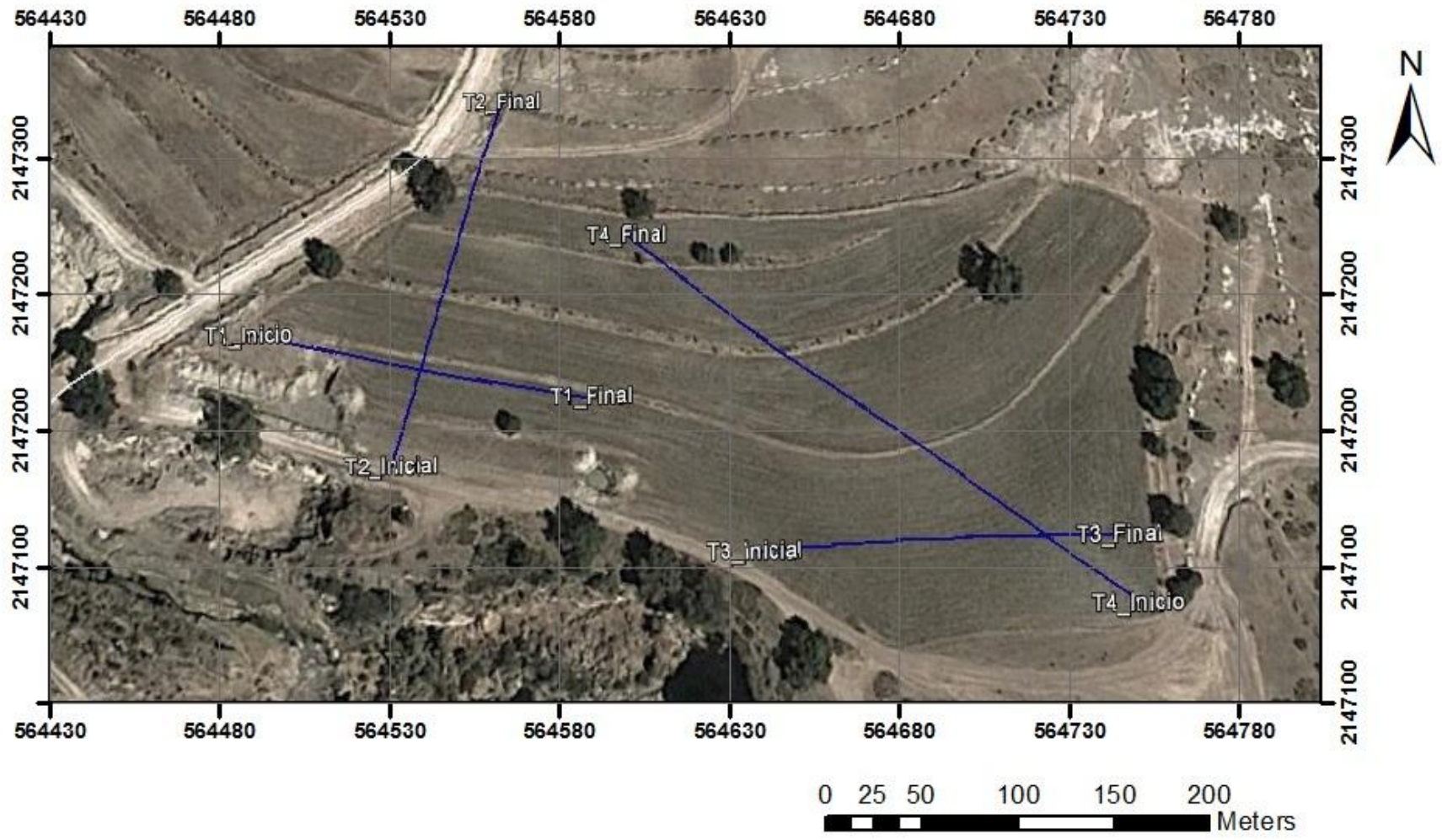
Fig. 1.10 Distribución de los tendidos de tomografía eléctrica en la zona de estudio
