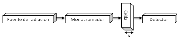
Figura 2.7 Diagrama de un espectrofotómetro ultravioleta-visible [60].
