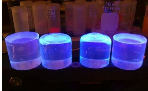
FIGURA 1.12: Plástico centellador emitiendo luz al ser irradiada con una fuente de luz ultravioleta. Fotografía tomada en el Laboratorio de Materiales, FCFM-BUAP
