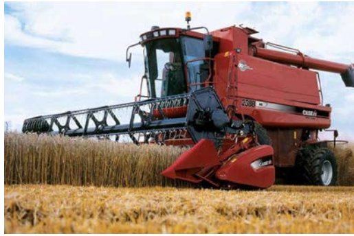
Figura 5. Cosechadora moderna la cual tiene la capacidad de realizar la cosecha, trillado y aventado (Precop, 2017).
