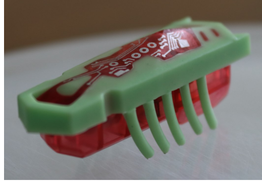
Figura 3.1: Imagen de un Hexbug , un microrobot con motor de vibración utilizado en el experimento para simular el movimiento de partículas autopulsadas.
