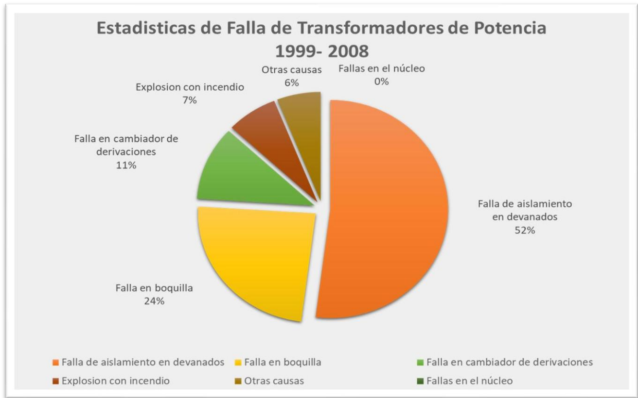
Figura 4.1 Gráfica de Fallas de Transformadores de Potencia [12]
