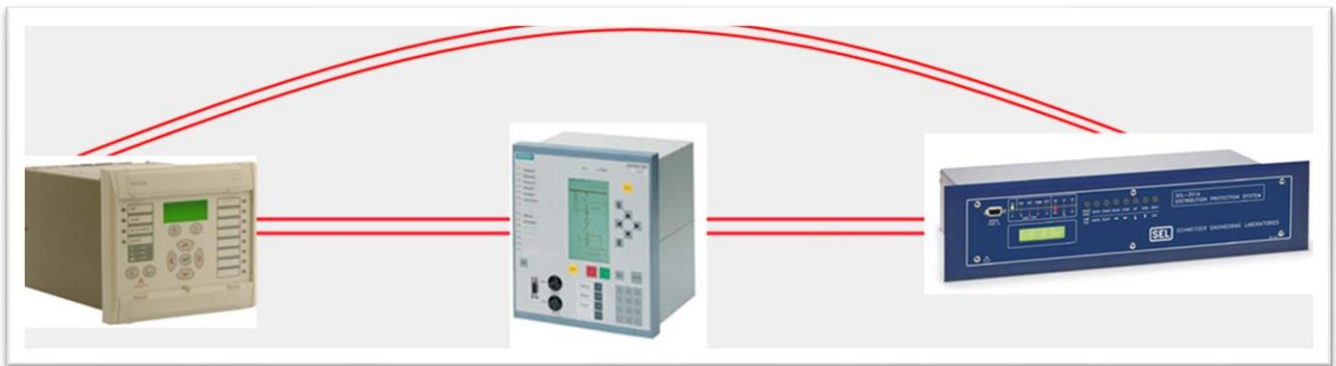
Figura 5.4 Esquema de protección para fallas simultáneas tipo distribuido
