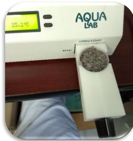
Figura 28. Medición de actividad de agua.
