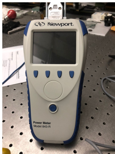
Fig. 7. Potenciómetro óptico modelo 843-R de la marca Newport™.
