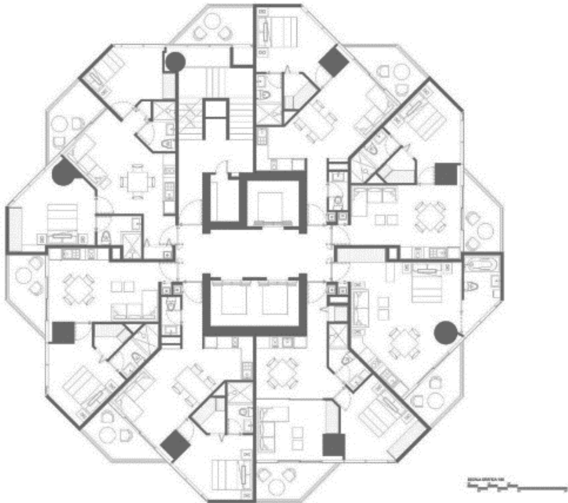
PLANTA ARQUITECTÓNICA TIPO NIVELES 4,6,8,10
