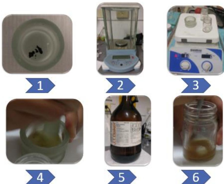
**Fig. 5** Fuente propia. Síntesis de Hidrogel de quitosano/ extracto etanólico *Rumex obtusifolius*
