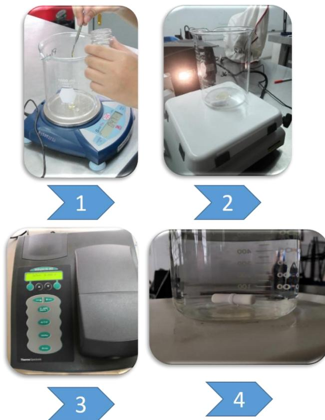
*Fig. 6 Fuente propia. Cinética de disolución del Hidrogel de quitosano/Rumex obtusifolius*
