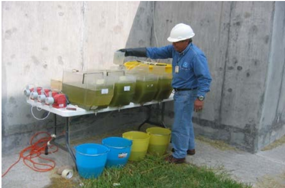
Vista de reactores de tratabilidad (cuatro reactores)
