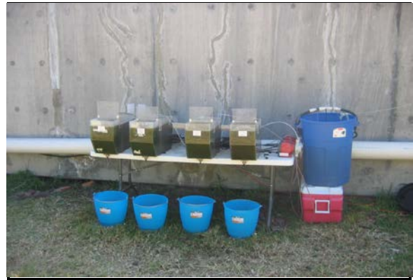
Elementos necesarios para el estudio de tratabilidad, Celdas de Eckenfelder, Bombas de aire, cubetas y alimentación de agua
