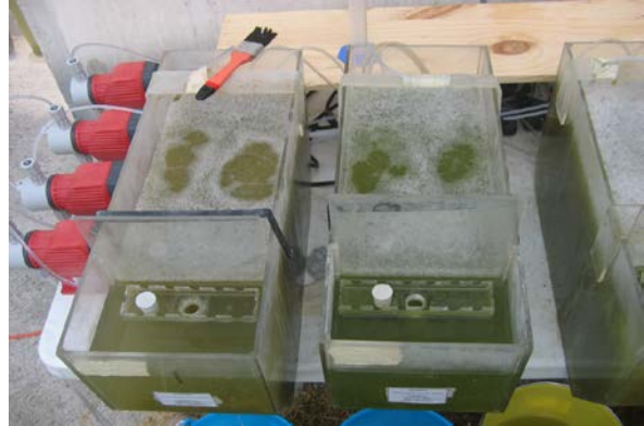
Reactores de lodos activados aireados
