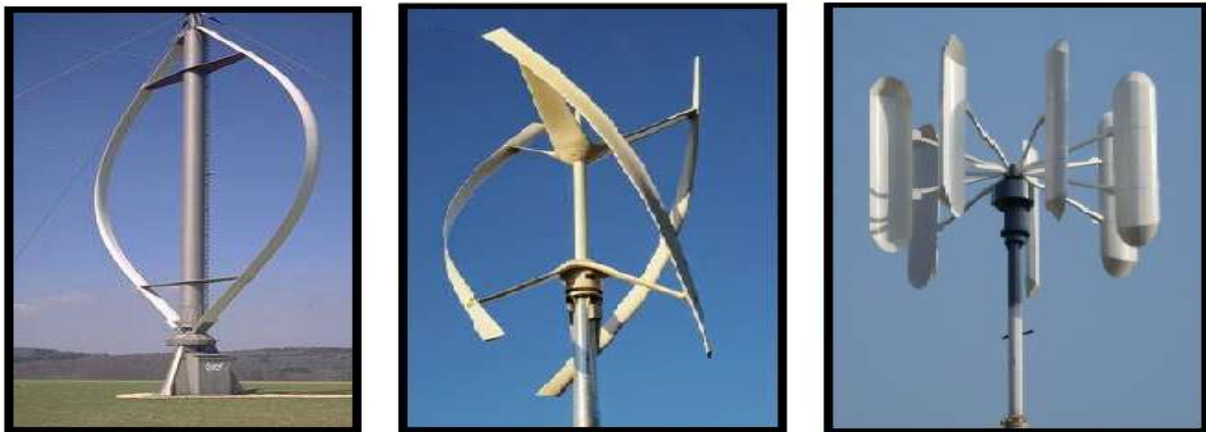
Figura 1.4: Renovables Verdes (2017). Tipos de aerogeneradores VAWT (De izquierda a derecha: Tipo Daerrius, tipo Savonius, tipo Panémoma).
