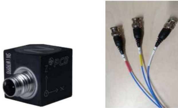
Figura 2.6: Acelerómetro triaxial PCB Piezotronics, model 356A17 y cable trifurcado complemento del acelerómetro.
