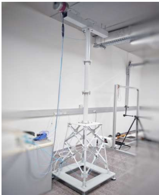
Figura 2.1: Ensayo experimental aerogenerador offshore con soporte tipo jacket en el laboratorio.
