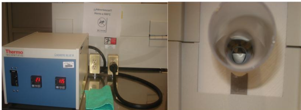
Figura 2.2. Fotografías del horno tubular empleado para la transformación de ZnO_2 en ZnO .
