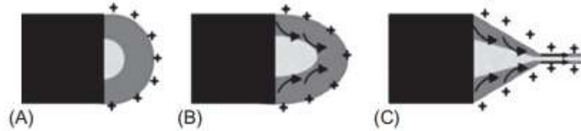
Figura 1.4 Esquema que ilustra la formación del cono de Taylor en el inyector coaxial. A) Cargas en la superficie b) Formación de la coraza en la gota c) Cono de Taylor para la formación de la coraza.
