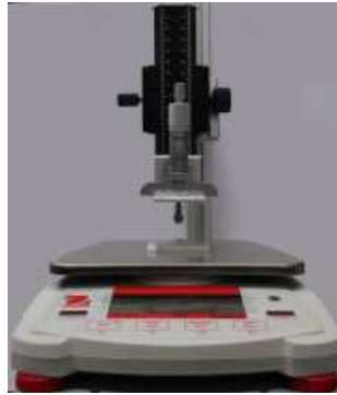
Figura C.1: Fotografía del experimento para obtener el momento magnético entre dos imanes.
