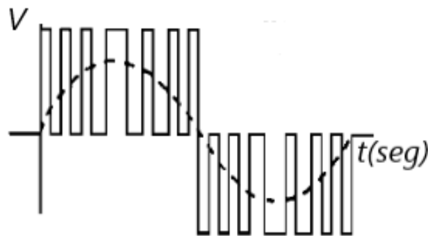
Figura 3.24: Voltaje entre las fases U y V [30].
