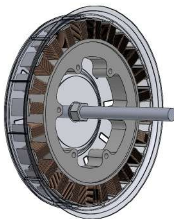
Figura 2.30: Ensamble rotor del y del estátor.
