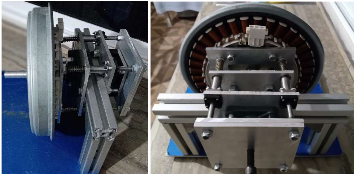
Figura 2.33: Motor trifásico tipo Brushless, ensamble real.
