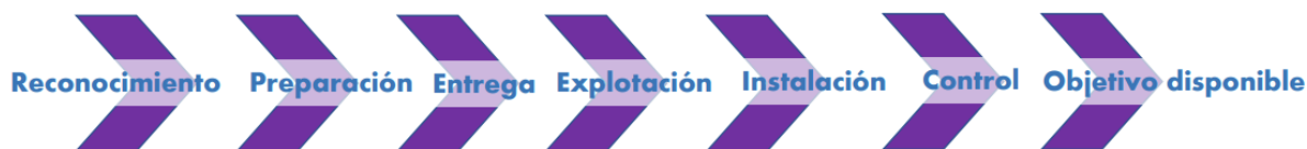
Figura 17. Etapas de un ataque, basado en la cadena de eliminación (Fuente: Imagen de elaboración propia)
