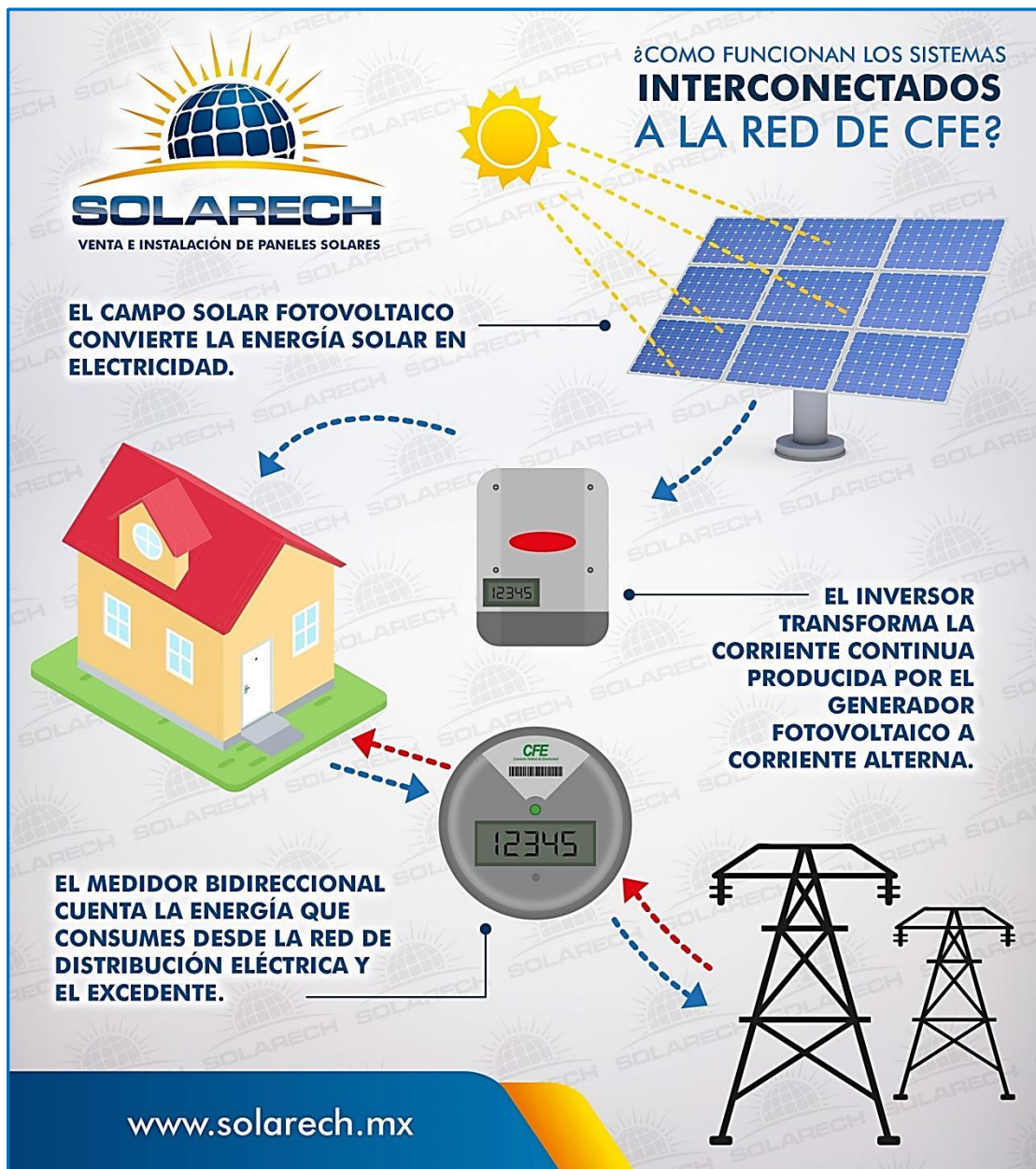
Figura 3.4 Sistema Fotovoltaico interconectado
