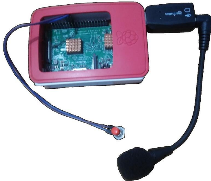
Fig. 10. Sistema Empuotrado para la obtención de señales de audio.
