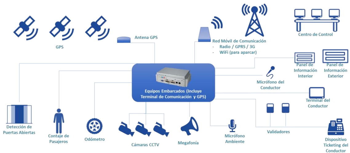
Figura 4 Arquitectura general del sistema Fuente: GMV
