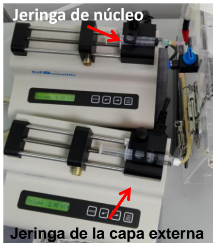
Figura 2.4. Colocación de jeringas del sistema coaxial.
