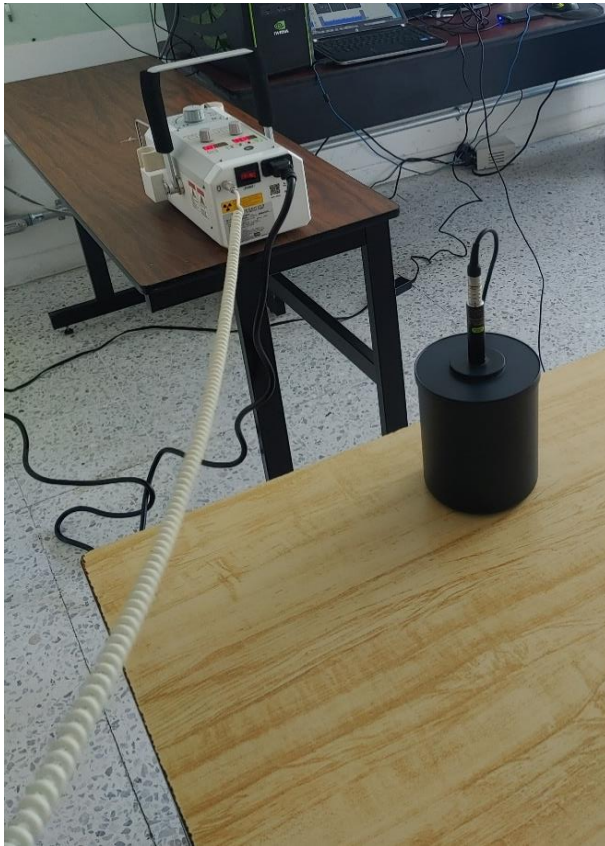
Figura 18 Arreglo experimental de radiación de fuga: Cámara de ionización 10X6-1800 colocado detrás del haz del tubo de rayos X
