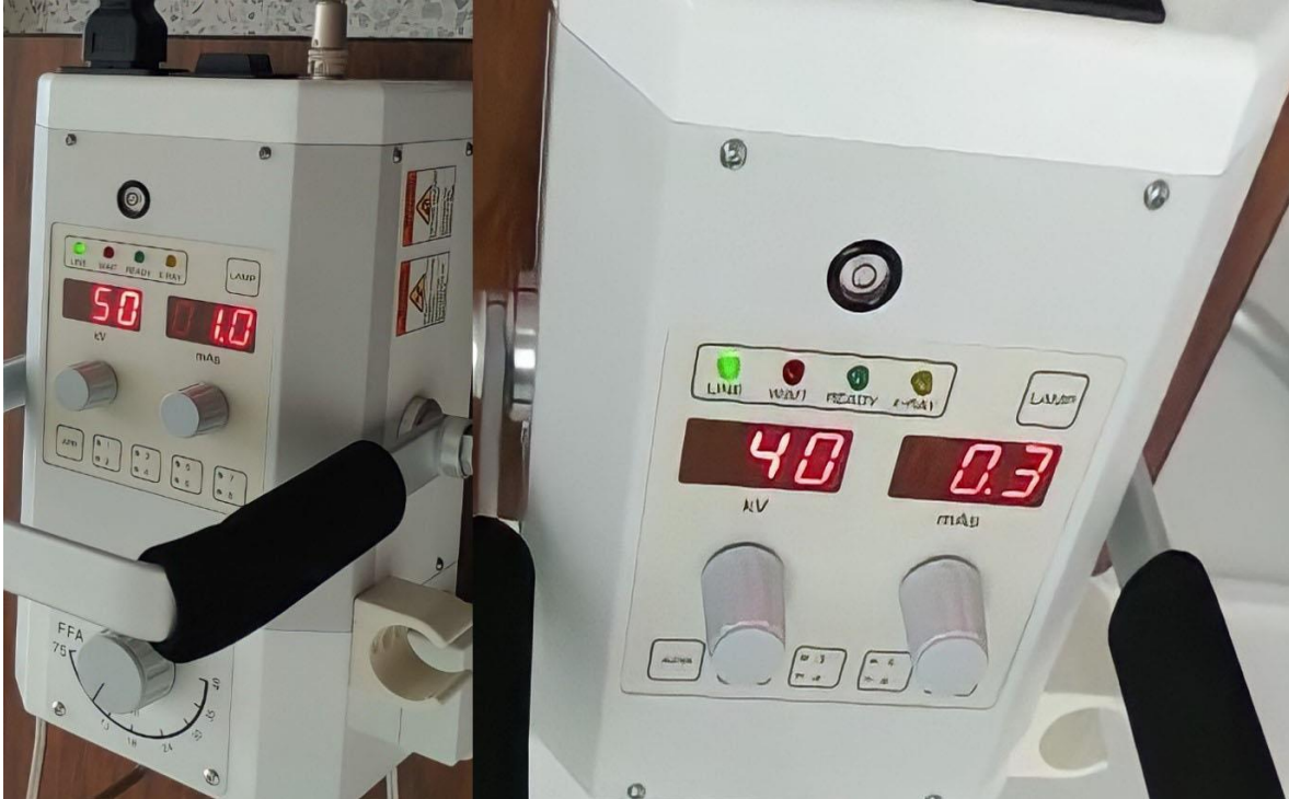
Figura 24 : Evidencia de la indicación visual que proporciona el tubo de rayos X PORTA-100HF
