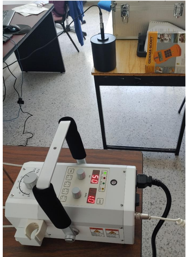
Figura 17 Arreglo experimental de radiación de fuga: Cámara de ionización 10X6-1800 colocado a la izquierda del tubo de rayos X
