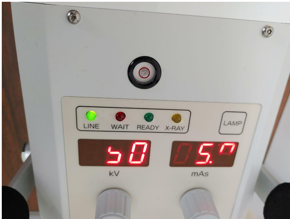
Figura 19 Pruebas de la indicación visual del tubo de Rayos X
