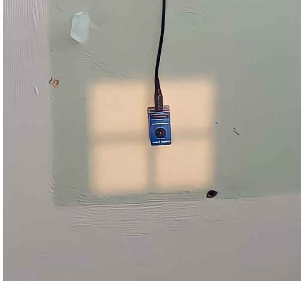
Figura 26 Definición visual del campo luminoso previo al haz de rayos X
