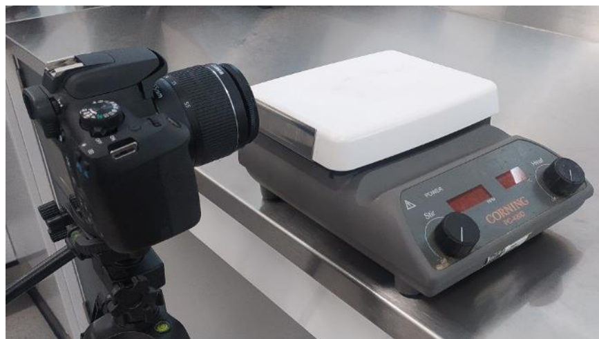
Figura 14: Arreglo experimental usado para la medición del ángulo de contacto.
