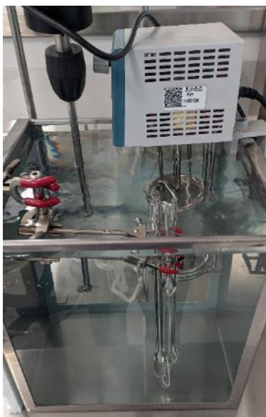
Figura 13: Arreglo experimental empleado para la determinación de viscosidad de disoluciones de polímero y compuesto de bajo peso molecular.
