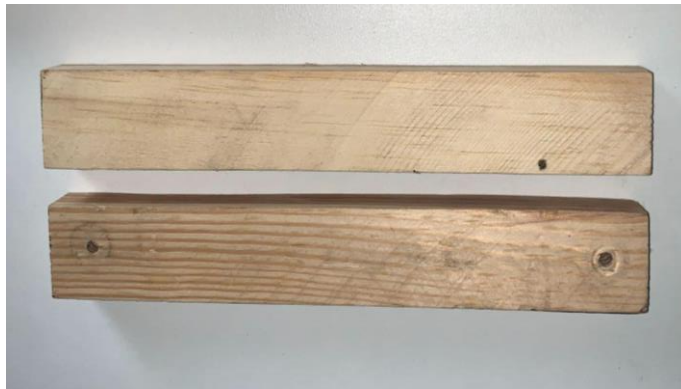
Fig. 3.3 Ligamentos frontales derecho e izquierdo realizados en madera de pino.
