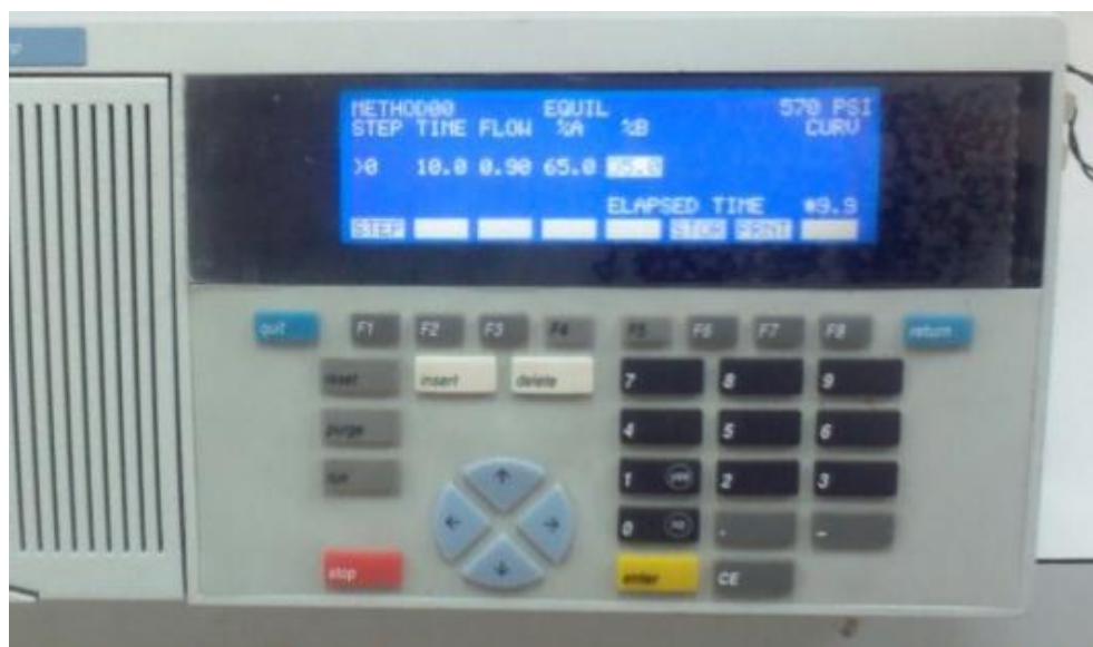
Figura 16. Monitor para variar la velocidad de flujo de la fase móvil del equipo de HPLC .
