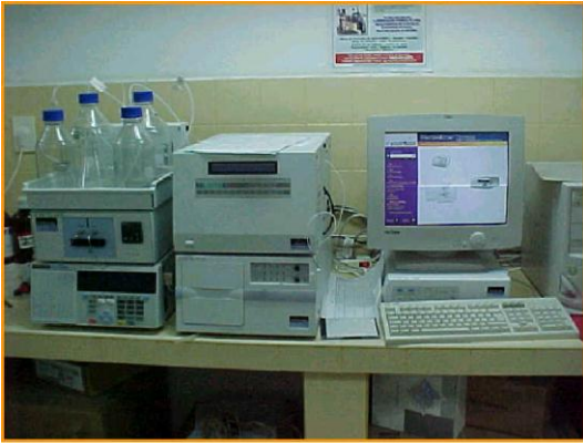
Figura 4. Equipo HPLC, con frascos para la fase móvil. Frasco con agua (reservorio A ) y frasco con disolvente (reservorio B).
