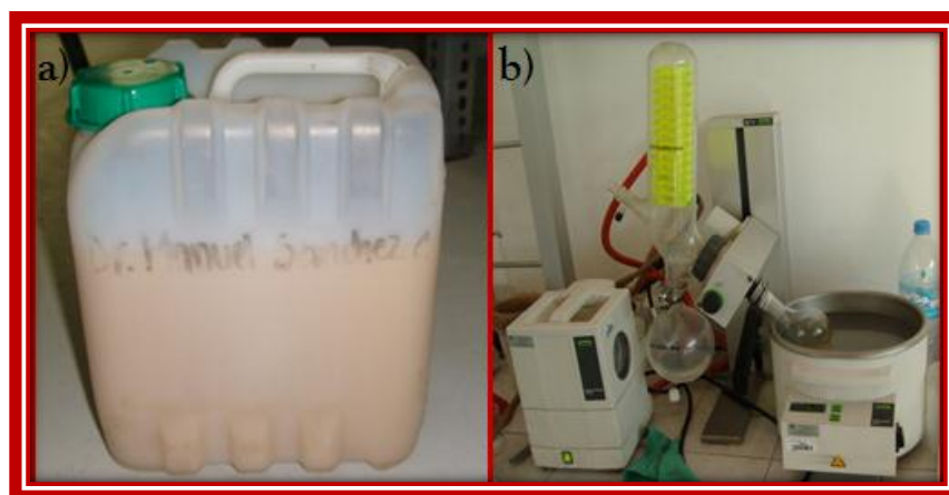
Figura 2.9 a) Macerado de aceite, b) Eliminación de metanol.
