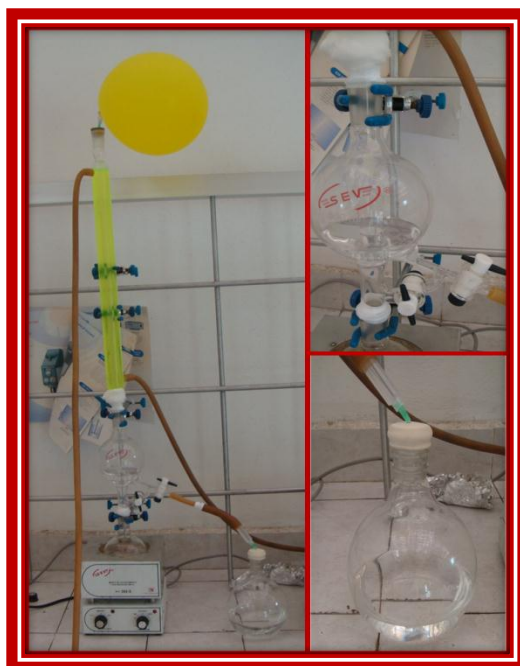
Figura 2.6 Secado de metanol.
