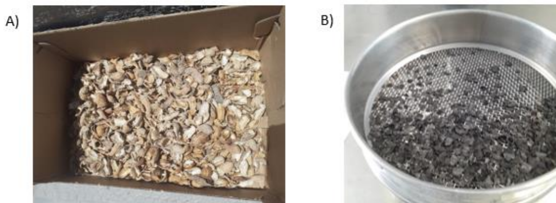
Figura 10 A) Cáscara de cacahuate inicial, B) Carbón activado resultante (CAC). Fuente: Elaboración propia
