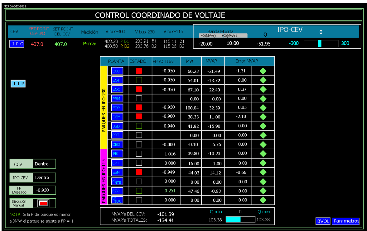
Figura 3.4 Control Coordinado de Voltaje Centrales Eólicas
