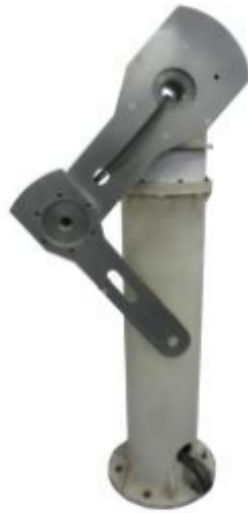
Figura 4.1: Plataforma experimental robot antropomórfico de 3gdl
