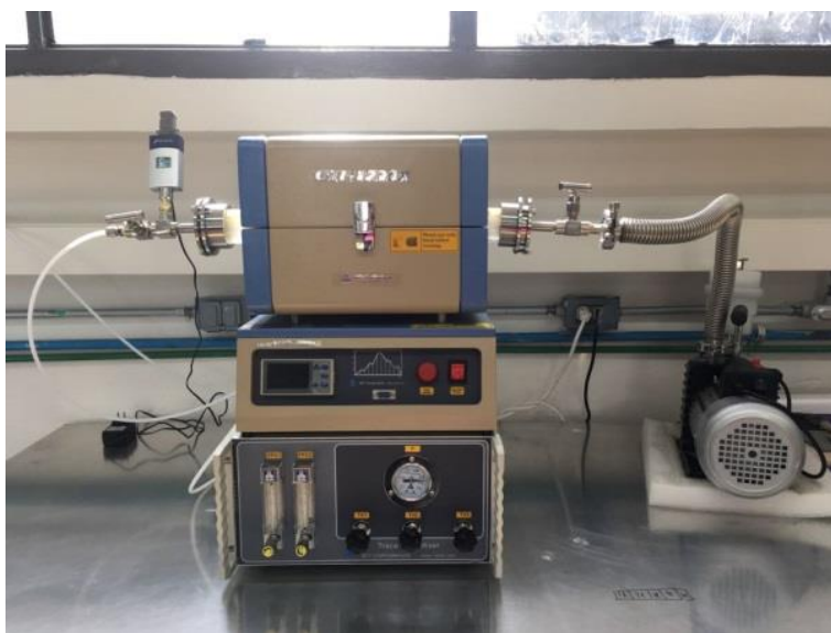
Figura 3.5. Horno tubular utilizado para tratamiento post-depósito.
