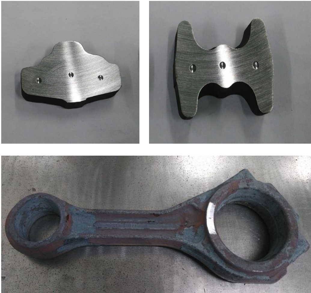
Figura 3.12. Medición de dureza superficial y de núcleo de acuerdo a las secciones para análisis, ver Figura 3.11
