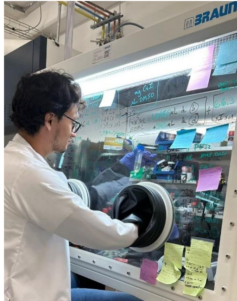
Figura 3.2: Cámara de guantes usada para la elaboración del \text{TiO}_2 .
