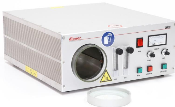
Figura 3.1: Equipo de plasma usado para la limpieza de las muestras.
