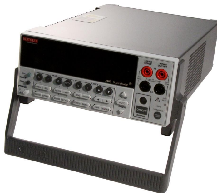
Figura 2.3: Ejemplo de un equipo SMU (Keithley 2400).
