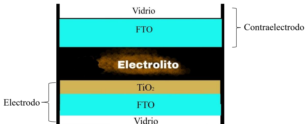
Figura 3.12: Esquema de la celda electroquímica armada.
