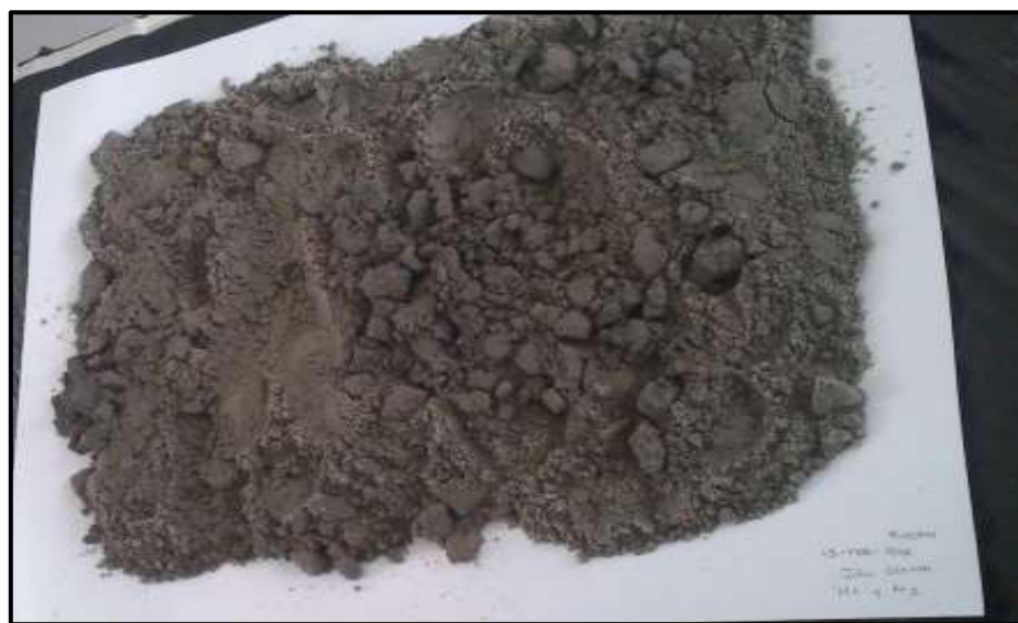
Imagen 1. Secado de la muestra jal.
