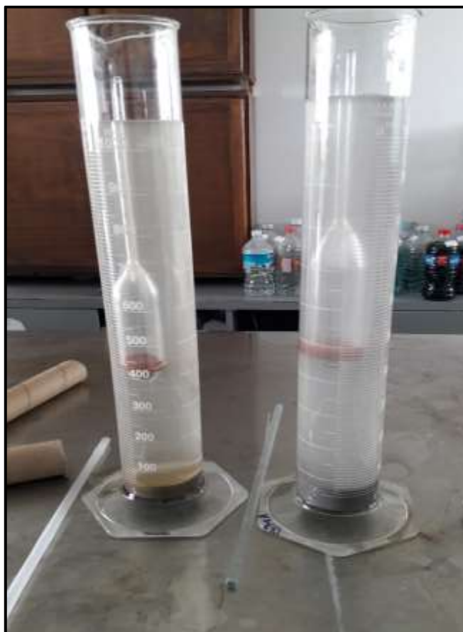
Imagen 7. Determinación de la textura del jal.
