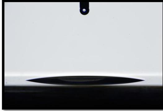
Figura 27. Observación del ángulo de contacto, experimento 4 PLA-DEPEG<sub>500</sub>.
