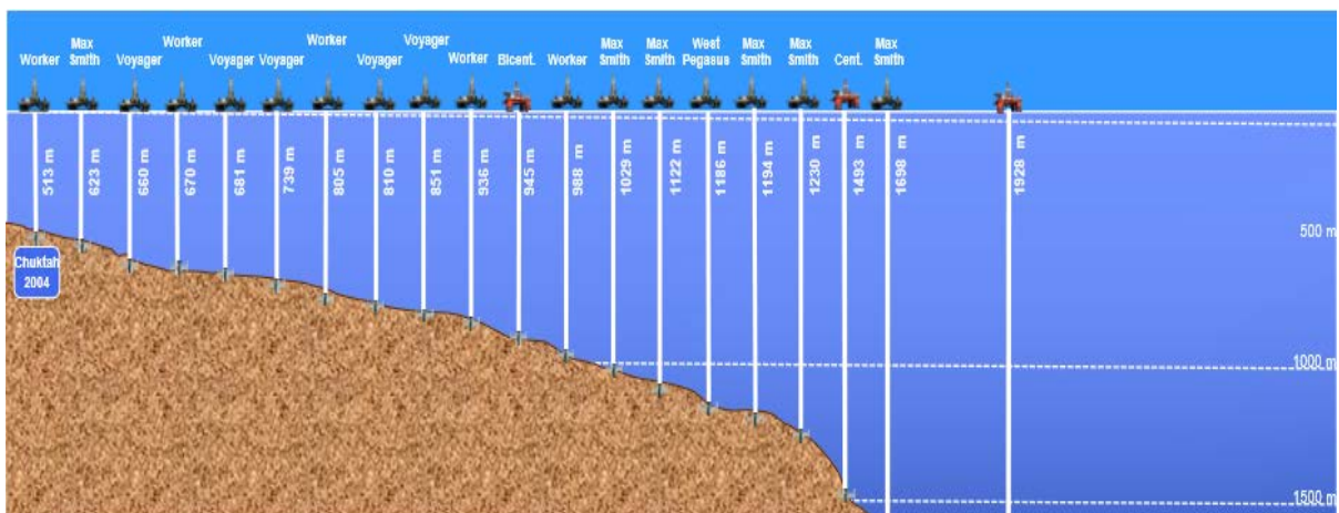
Figura 10. Esquema de la evolución de los equipos de perforación y de las habilidades técnicas que permiten hoy perforar en Aguas Ultra-Profunda
