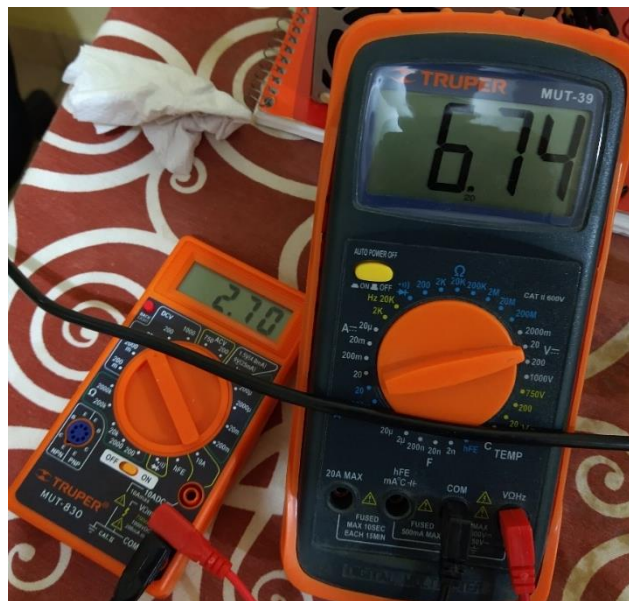
Figura 33: Voltaje de L298N prototipo 1 Fuente: Captura propia
