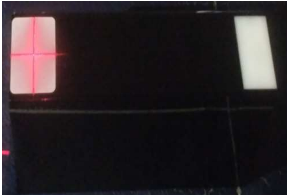
Figura 12: Fantoma, herramienta para poder calibrar el densitómetro Fuente: Área de trabajo HUP,2022
