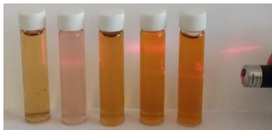
Figura 4.1. Soluciones de nanopartículas de plata de izquierda a derecha el extracto de Tomillo ( Thymus vulgaris ) seguido de las soluciones de AgNPs a pH, 5, 7, 8 y 9.
