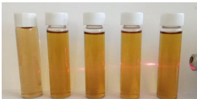
Figura 4.13. Efecto Tyndall de las soluciones de las \text{Cu}_2\text{ONPs} obtenidas con el extracto de Taraxacum officinale (Diente de León), de izquierda a derecha el extracto seguido de las soluciones de \text{Cu}_2\text{ONPs} a pH 5, 7, 8, 9.
