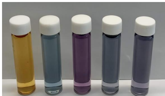
Figura 4.3. Soluciones de nanopartículas de oro preparadas con el extracto de Tomillo ( Thymus vulgaris ), de izquierda a derecha el extracto de Tomillo seguido las soluciones de AuNPs a pH, 5, 7, 8 y 9.
