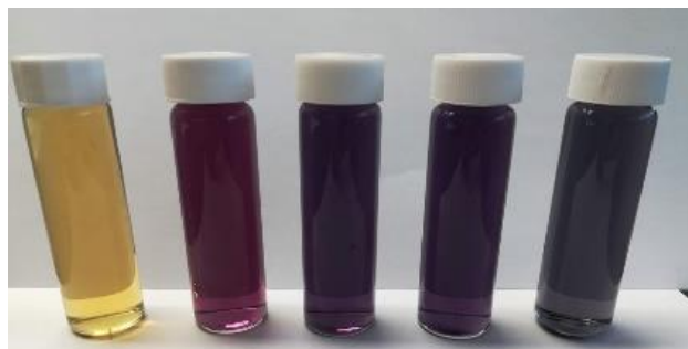
Figura 4.27. Soluciones de nanopartículas de oro AuNPs preparadas con el extracto de Ocimum basilicum (albahaca) a diferentes pH.
