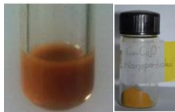
Figura 2.13. Color de las Nanopartículas de \text{Cu}_2\text{O} (Marcos, 2016; Khan, 2016).
