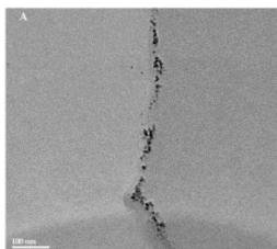
Figura 2.35. Imagen TEM de bajo aumento del brote de alfalfa que muestra una matriz unidimensional de nanopartículas de plata.
