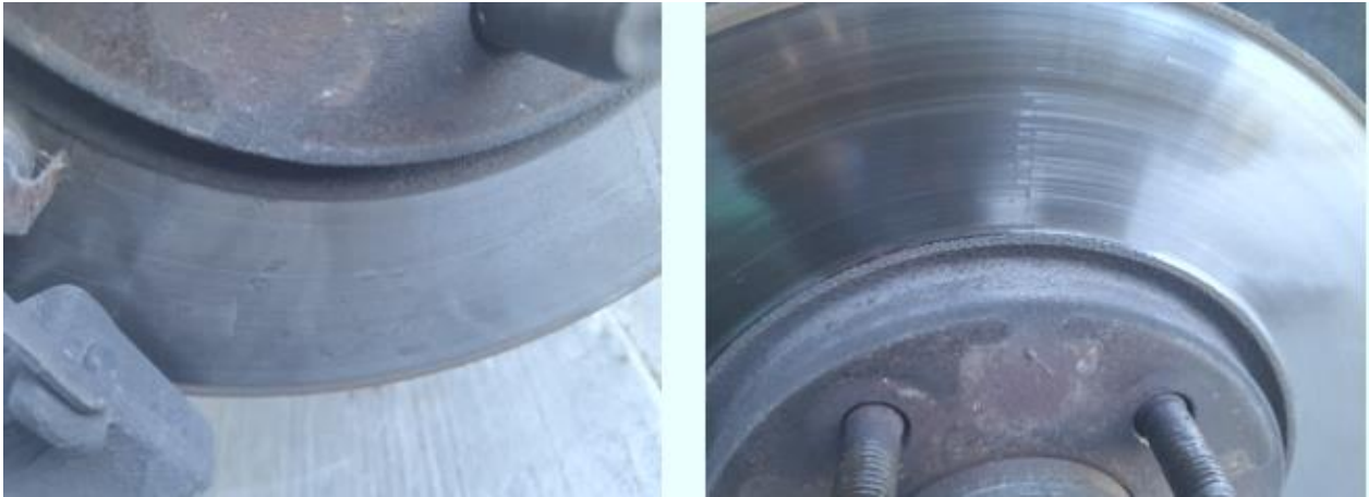
Figura 19. Desgaste excesivo del disco.
