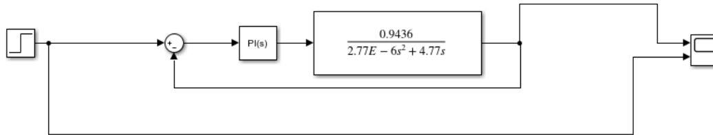
Figura 45. Diagrama a bloques de sistema de control del motor 2.
