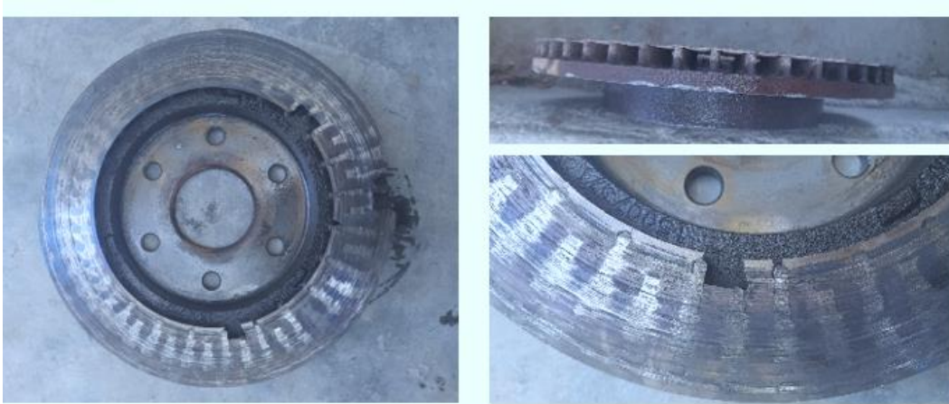
Figura 21. Disco desgastado en exceso por balatas deterioradas.
