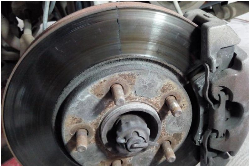
Figura 48. Disco 1 de pruebas fracturado.
