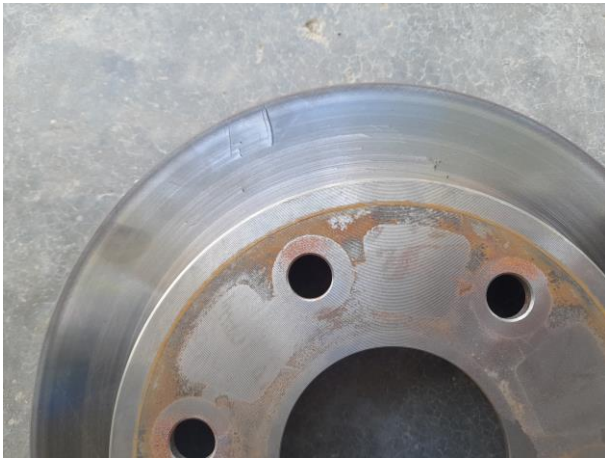
Figura 18. Disco dañado por holgura excesiva de rodamientos.
