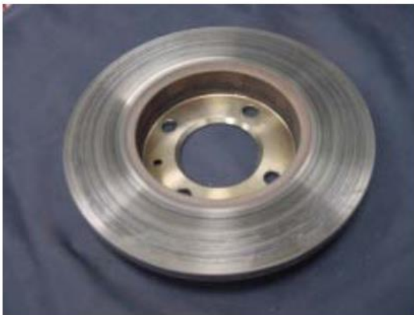
Figura 17. Desgaste por montaje incorrecto del caliper [29].
