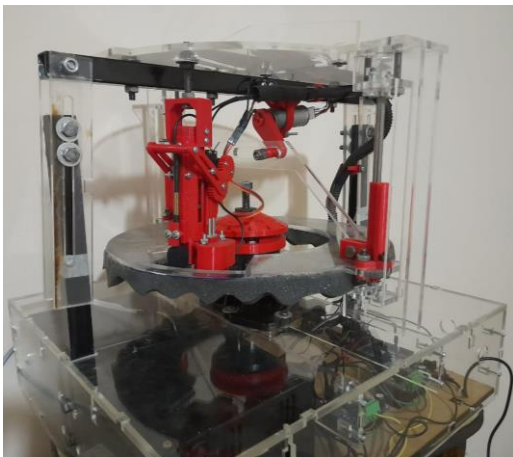
Figura 29. Prototipo detector de fallas en discos de frenos.
