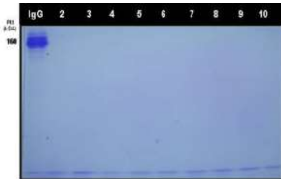
Figura 12. Separación de proteínas por electroforesis de los sobrenadantes de cultivos bacterianos. (A)- sin precipitar, y (B)- concentrados proteicos del sobrenadante de las cepas de origen clínico. Análisis en SDS-PAGE al 10%, proteínas incubadas durante 3 h a 37 C. A) Carril: IgG (control)=10 \mu g; 2: E. coli DH5 \alpha ; 3: cepa 97 ( C. amalonaticus ); 4: cepa 112 ( P. penneri ); 5: cepa 114 ( K. oxytoca ); 6: cepa 122 ( E. coli ); 7: cepa 131 ( E. coli ); 8: cepa 132 ( K. pneumoniae ); 9: cepa 134 ( P. aeruginosa ); 10: cepa 137 ( E. coli ). B) Concentrados proteicos de sobrenadante con el mismo orden de muestras de la figura A.
