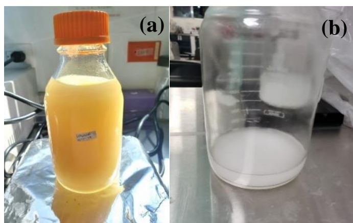
Figura 3.1. a) disolución acuosa de \text{NaClO}_2 , KOH y celulosa próxima a alcanzar el tiempo establecido (30 min). b) disolución acuosa de celulosa posterior a la centrifugación y a sus lavados correspondientes, antes de ser filtrada.
