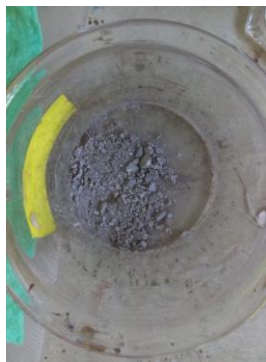
Figura 14. Solución completamente seca del catalizador preparado por el método de impregnación al 1% Ag/ZnO.
