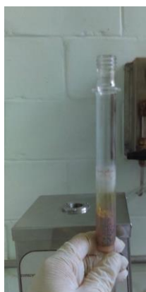
Figura 15. Catalizador preparado por el método de impregnación al 1% Ag/ZnO, dentro de un tubo, listo para calcinar en el reactor de borosilicato.
