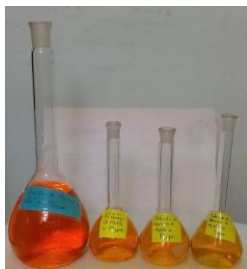
Figura 17. Solución de naranja de metilo de 20 ppm, 15 ppm, 10 ppm, y 5 ppm; respectivamente.
