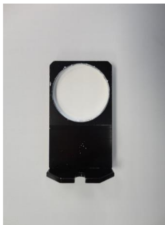
Figura 42. Placa para colocar muestra del catalizador en el equipo por Difracción de Rayos X.
