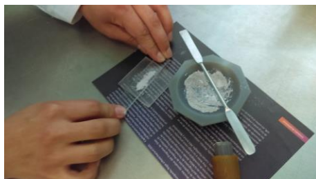
Figura 29. Preparación de catalizador para ingresarlo al equipo de Difracción de Rayos X.
