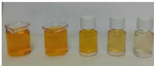
Figura 25. Muestras de la degradación de la solución de naranja de metilo, utilizando el catalizador preparado por el método de impregnación al 5% Ag/ZnO.
