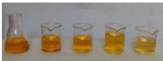
Figura 22. Muestras de la degradación de la solución de naranja de metilo, utilizando el catalizador preparado por el método de impregnación al 2% Ag/ZnO.
