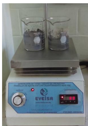
Figura 13. Soluciones de los catalizadores preparados por el método de impregnación al 1% Ag/ZnO, y 2% Ag/ZnO; respectivamente, sobre la parrilla de agitación y calentamiento.
