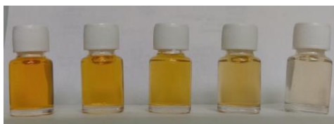
Figura 23. Muestras de la degradación de la solución de naranja de metilo, utilizando el catalizador preparado por el método de impregnación al 3% Ag/ZnO.
