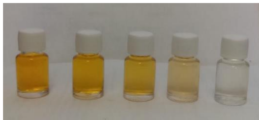
Figura 24. Muestras de la degradación de la solución de naranja de metilo, utilizando el catalizador preparado por el método de impregnación al 4% Ag/ZnO.
