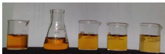
Figura 21. Muestras de la degradación de la solución de naranja de metilo, utilizando el catalizador preparado por el método de impregnación al 1% Ag/ZnO.
