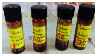
Figura 18. Frascos con muestras de la solución de 5 ppm, 10 ppm, 15 ppm, y 20 ppm; respectivamente.
