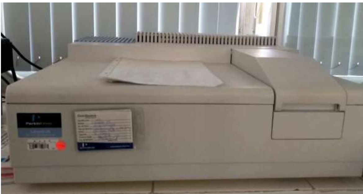
Figura 2.7. Espectrofotómetro Perkin Elmer Lambda 25 utilizado para medición de las muestras por espectrofotometría UV-Visible.
