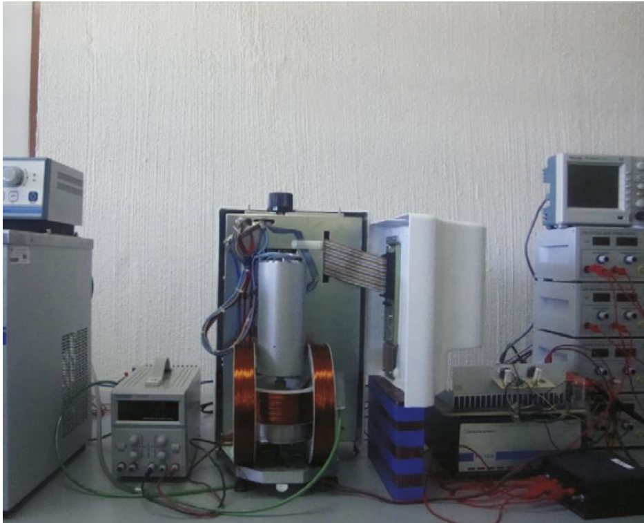
Figura 2.2 Arreglo experimental para la realización de las pruebas reológicas. Se observa el arreglo de bobinas para el Campo Estático (bobina horizontal) y el sinusoidal (bobinas verticales).
