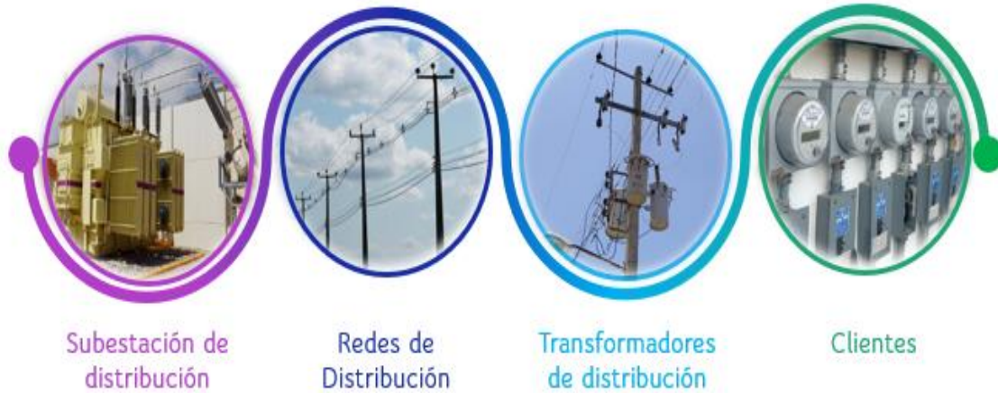
Figura 1. Resumen de un sistema eléctrico de distribución.
