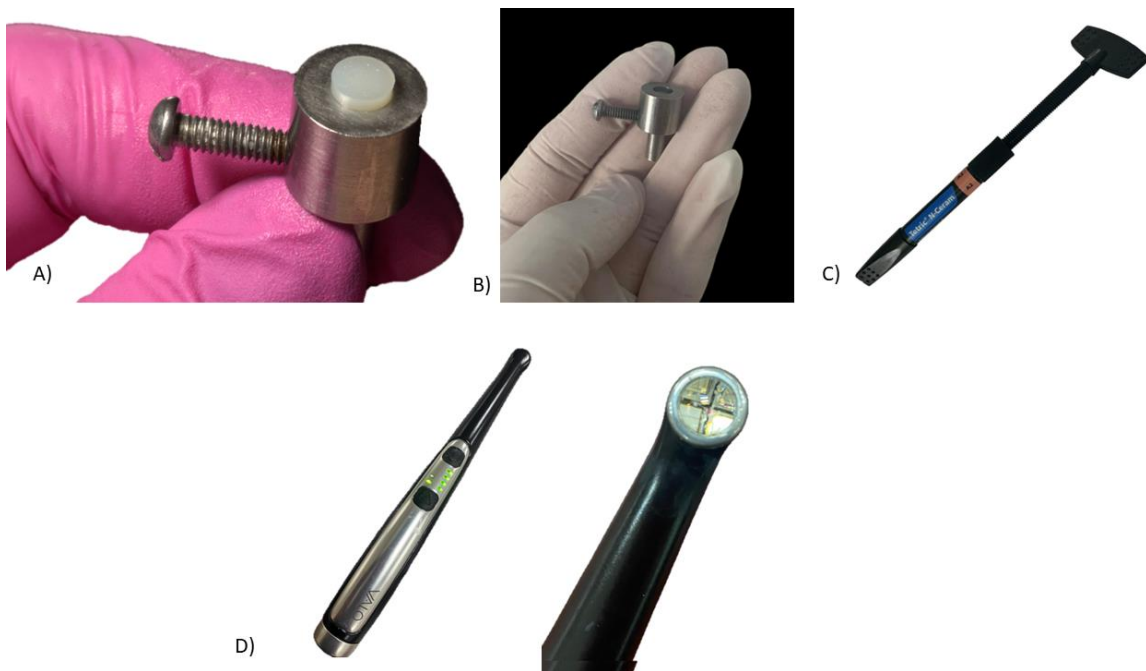
Figura 11. A) Pastilla de resina en molde. B) Molde de acero inoxidable de 5 mm de diámetro por 1.5 mm de altura. C) Resina Tetric N-Ceram, Ivoclar Vivadent. D) Lámpara poliwave Valo Ultradent. (Fuente propia).
