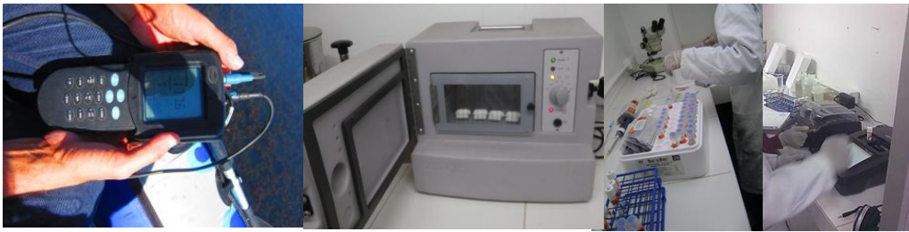
Figura 5.3.1. Equipos para la medición de variables física y químicas en laboratorio. 7a. HACH; 7b. Incubadora; 7c. Análisis de muestras; 7d. Medición de amonio y fosfatos con un espectroquant NOVA 60 marca MERCK.
