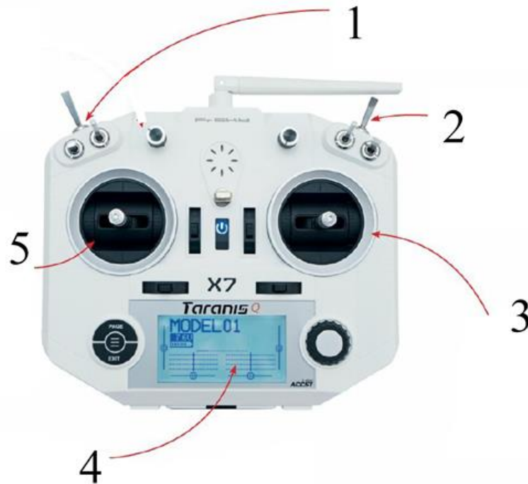
Figura 39. Partes básicas de un control remoto
