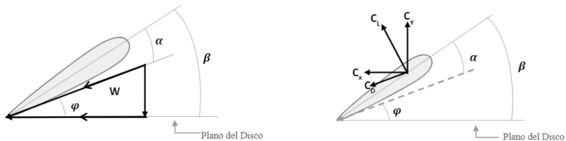
Figura 10. Velocidades y fuerzas sobre el elemento de la hélice
