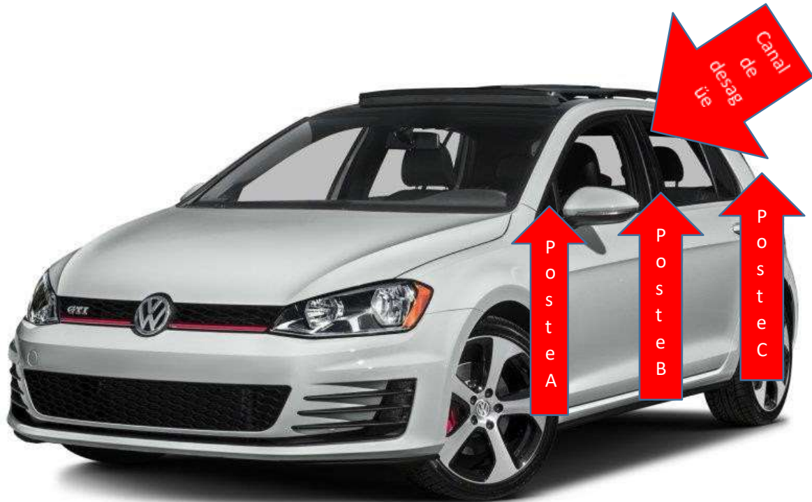
Zonas de afectación en la carrocería
