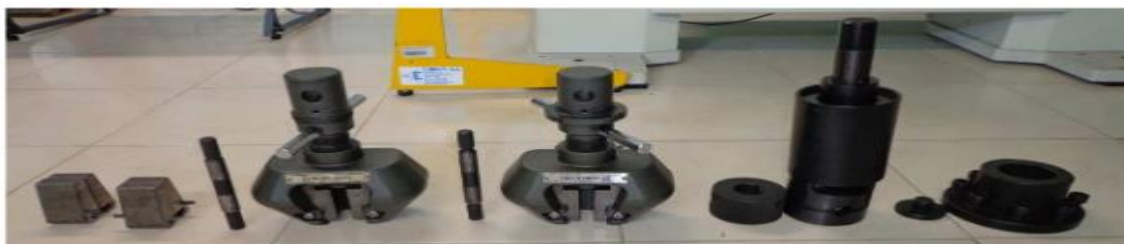
Figura 2.25. Piezas de la maquina autograph shimadzu.
