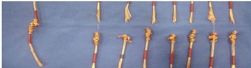
Figura 2.30. Ejemplos de empalmes eléctricos sometidos a tracción.
