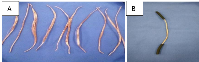
Figura 2.5. Cable automotriz: A). Ejemplos de cable automotriz. B). Probeta de cable automotriz.
