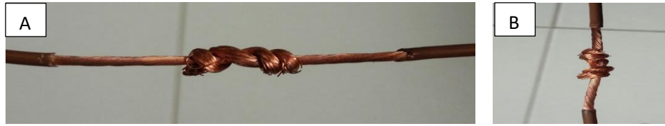
Figura 2.9. Empalme ballhanger: A). Empalme ballhanger en horizontal. B). Empalme ballhanger en vertical.
