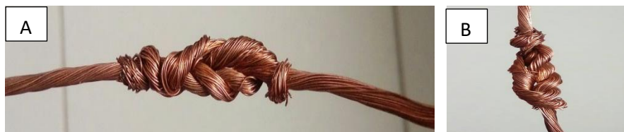
Figura 2.14. Ejemplos de empalmes tipo cirujano: A) Empalme cirujano en horizontal. B) Empalme en vertical.
