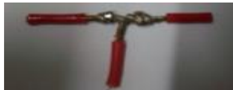
Figura 2.2. Empalme derivación de conductores.
