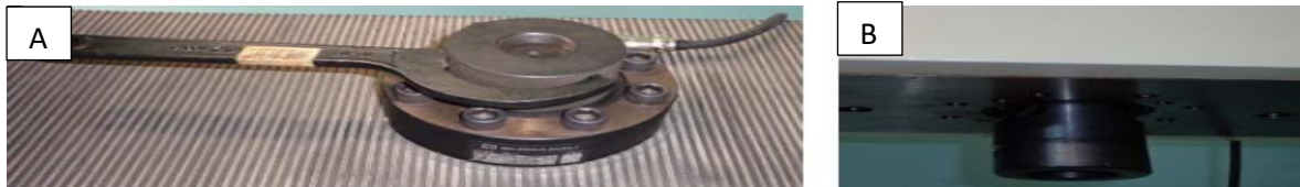
Figura 2.27. Ensamblado de maquina universal: A) Colocación de la unión universal articulada. B) Finalización de la colocación de la unión articulada.
